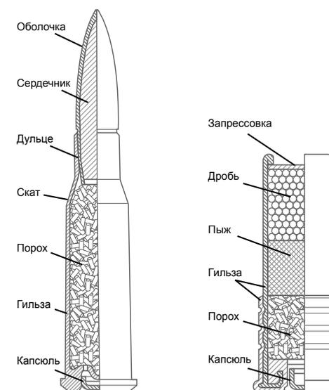
Схема патронов для гладкоствольного (слева) и нарезного оружия
