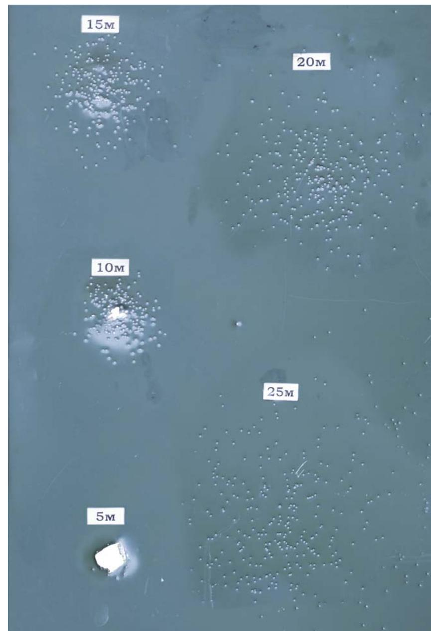
Выстрелы производились из гладкоствольного ружья 12 калибра с расстояния от 5 до 25 м свинцовой дробию № 7 (Ø 2,5 мм) по стальному листу толщиной 0,5 мм.
