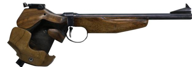
Максимальная масса спортивного пистолета, в соответствии со Спортивным регламентом, должна составлять до 1400 г, а усилие спуска не должно быть меньше 1000 г. Регулировочные винты для тонкой настройки отдельных компонентов спускового механизма должны быть хорошо видны и просты в обращении.
